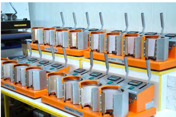
Profipress: Aufpressen der Bilder auf die Fototassen
