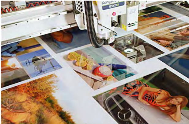
Kongsberg Schneidetisch: Vollautomatischer Zuschnitt der Großformatbilder
