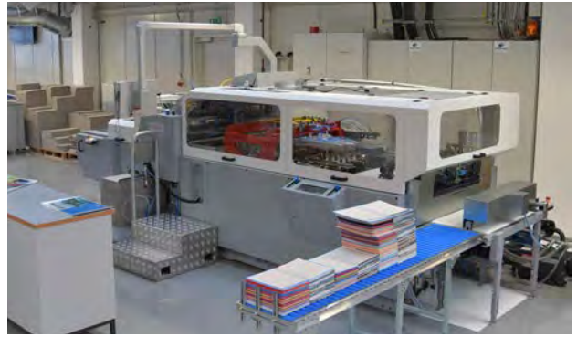
Deckenautomat: Auf dieser Maschine werden die Buchdeckel produziert.
