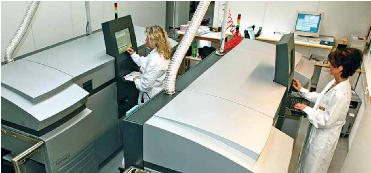
Die ISAG-fastPrints (Schweizer Präzisionsmaschinen) verfügen über DLP-Chips, die per Stunde insgesamt ca. 40.000 Farbbilder belichten. Diese werden in Folge im ÖKO-VSP 50 so umweltfreundlich wie möglich entwickelt (siehe Bild oben).
