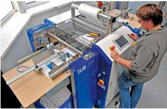
Foliant TLM 500: Zwei Laminiermaschinen verleihen den Titelblättern der Digital- und echtFotobücher den nötigen „Glanz“.
