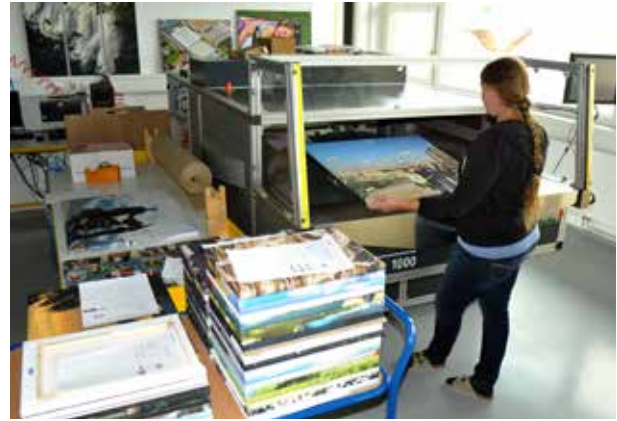
FastFrame: Vollautomatisches Bespannen der Holzkeilrahmen mit bedrucktem Canvas
