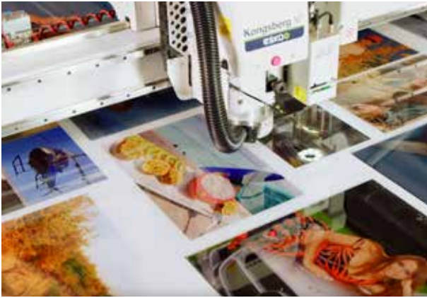
Kongsberg Schneidetisch: Vollautomatischer Zuschnitt der Großformatbilder
