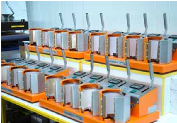
ProfiPress: Aufpressen der Bilder auf die Fototassen
