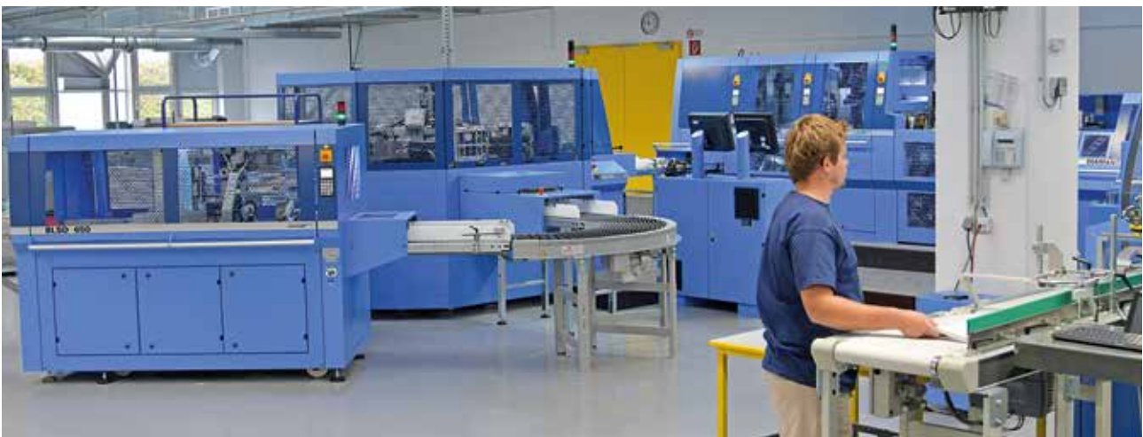
Buchfertigungsstraße: Auf dieser Anlage werden die Buchdecken mit den Buchblöcken vereint. Am Ende kommt das fertige Buch heraus.
