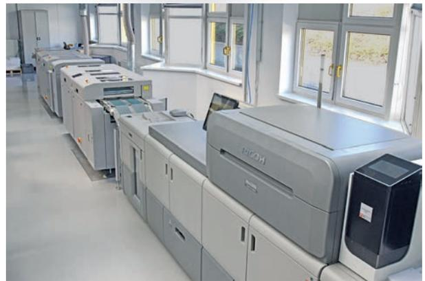
Ricoh PRO C9210 mit integriertem UV-Coater
