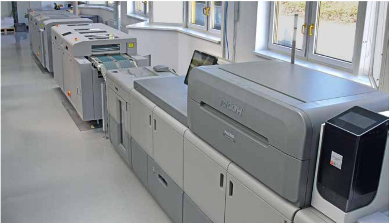
Ricoh PRO C9210 mit integriertem UV-Coater
